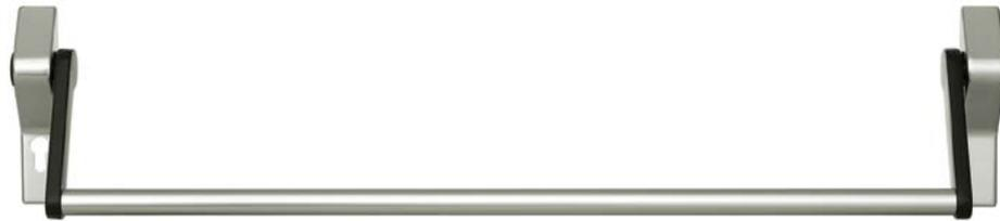
Durch das Zusammenspiel von Kegelradgetriebe und Vierkantstift wird beim Druck auf die Querstange die Drehbewegung für die Betätigung der Schlossnuss erreicht. Um die erforderlichen Prüfkräfte abfangen zu können, ist eine feste Anschlagbegrenzung eingebaut. Eine Feder sorgt dafür, dass der Stangenbeschlag nach der Betätigung in die Ausgangsposition zurückgestellt wird.
