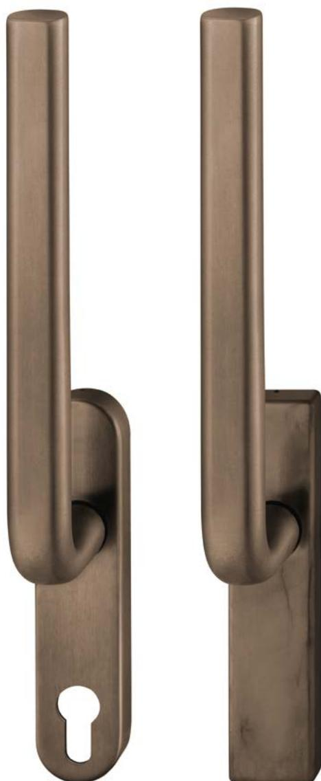
Hebe-/Schiebetürgriffe mit 180°-Rastung, festdrehbar gelagert, unsichtbare Verschraubung, Vierkantstift 10 mm
