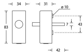
Abschließbare Fenstergriffe: **200 Nm** geprüft zum Schutz gegen gewaltsames Abreißen und gegen Abdrehen entsprechend **DIN EN 13126-3**.
