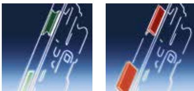
**Tagesfallenhaltfunktion** (Belegungspunkte 9 und 10, → siehe Seite M.58): Diese Funktion ermöglicht das ungehinderte Öffnen der Tür von beiden Seiten. So ist die Tür während der Geschäftszeit jederzeit begehbar, da Falle und Riegel permanent eingefahren bleiben. Bequem ist diese Funktion auch für den privaten Bereich, z.B. wenn man für kurze Zeit die Tür offen halten möchte. Durch Umlegen des Schalters wird die Tagesfallenhaltfunktion aktiviert.
