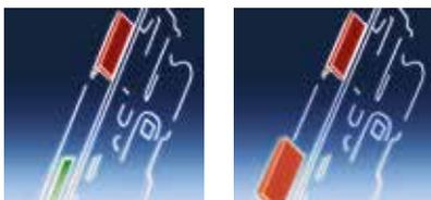
**Tagesfallenfunktion** (Belegungspunkte 11 und 12 → siehe Seite M.58): Bei dieser Funktion wird während des Tages die Tür nur über die Schlossfalle verriegelt. Ideal für stark frequentierte Türen, z.B. in Objektgebäuden oder Mehrfamilienhäusern bei denen ein kontrollierter Zutritt von außen erfolgen soll. Die Aktivierung erfolgt z.B. über eine Zeitschaltuhr oder einen Schalter. Diese Funktion ist nur mit der Fluchttürfunktion D möglich.
